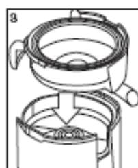
4. Plaats de filter in de sapverzamelaar. Zorg ervoor dat de filter stevig op de aandrijfas is gemonteerd. Het blad moet onder de rand van de pulpcontainer zitten wanneer het op zijn plaats zit.
