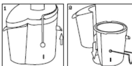
3. Plaats de sapverzamelaar in het apparaat. Zorg ervoor dat de rand goed op de motorunit zit.
