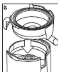
4. Setzen Sie den Filter in die Saftaufnahme ein. Achten Sie darauf, dass der Filter sicher auf der Antriebswelle sitzt. Die Klinge muss stets unterhalb der Oberkante des Tresterbehälters sitzen.
