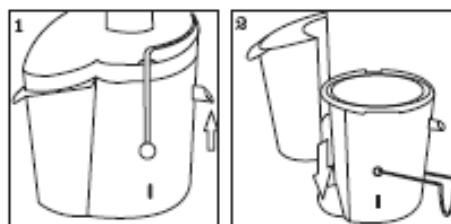
3. Setzen Sie die Saftaufnahme in das Gerät ein. Achten Sie darauf, dass die Oberkante bündig mit der Motoreinheit abschließt.
