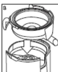
4. Installez le filtre dans le récepteur de jus. Assurez-vous que le filtre est correctement installé sur l'axe d'entraînement. La lame doit se reposer sous l'anneau du récepteur de pulpe lorsque celui-ci est installé.
