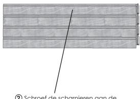
2 Schroef de scharnieren aan de broeikas zodanig, dat de ronding van het scharnier net buiten het raam valt
