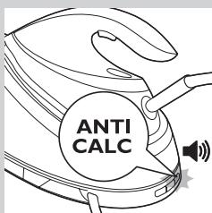
È molto importante sostituire la cartuccia ANTICALCARE quando la spia di sostituzione della cartuccia ANTICALCARE inizia a lampeggiare e l'apparecchio comincia a emettere un segnale acustico.
